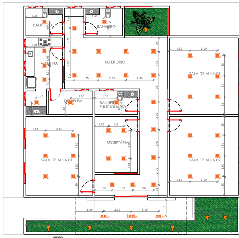
PLANTA BAIXA - ILUMINAÇÃO ESCALA: 1/100
