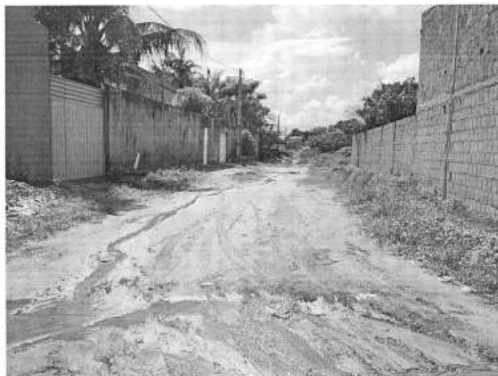
Rua Sara Fontinele. Com ponto inicial na estaca P15 e ponto final na estaca P16, com 322 m de comprimento e 6 m de largura.
