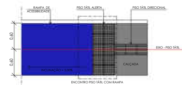
3 DETALHE - ENCONTRO PISO TÁTIL COM RAMPA ESCALA 1:50
