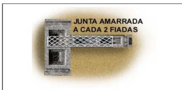
Figura 7: Junta com tela de aço entre alvenarias
