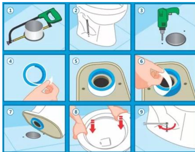
Figura 20: Processo de fixação das bacias sanitárias.
