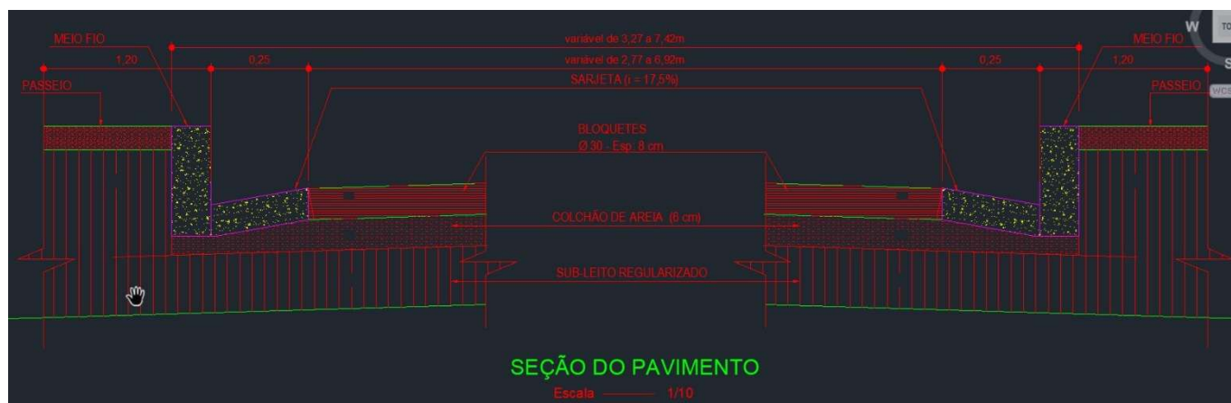
Imagem 05 – Detalhe da pavimentação em bloco sextavado.
