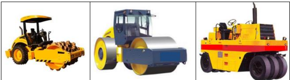
Figura 3 - Tipos de Rolos Compactadores (Tipo pé-de-carneiro, liso-vibratório e pneumático, respectivamente)
