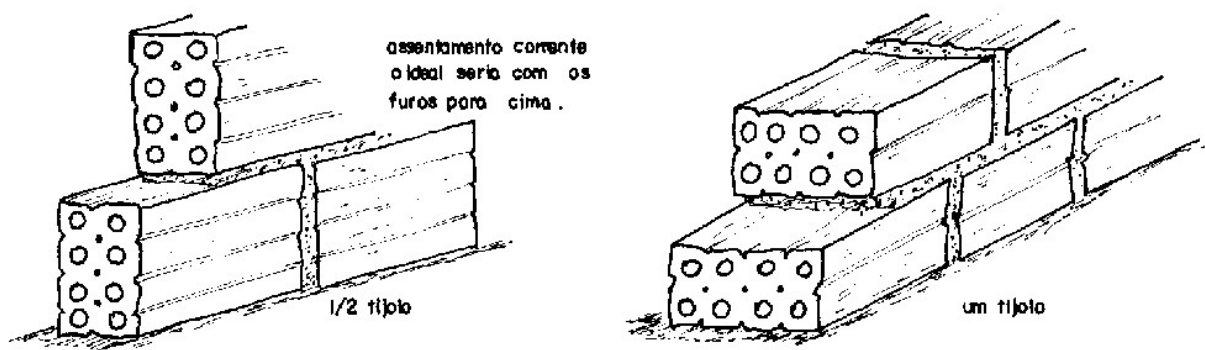
Figura 1 - Execução de alvenaria utilizando tijolos furados.
