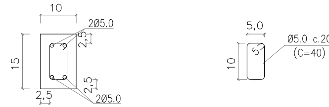
DETALHE DAS FERRAGENS CINTA DA AMARRAÇÃO ESCALA-----1/10
