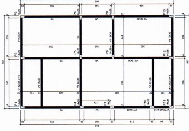
Forma do pavimento Nivel 0 Baldr (Nivel -5) escala 1:50
