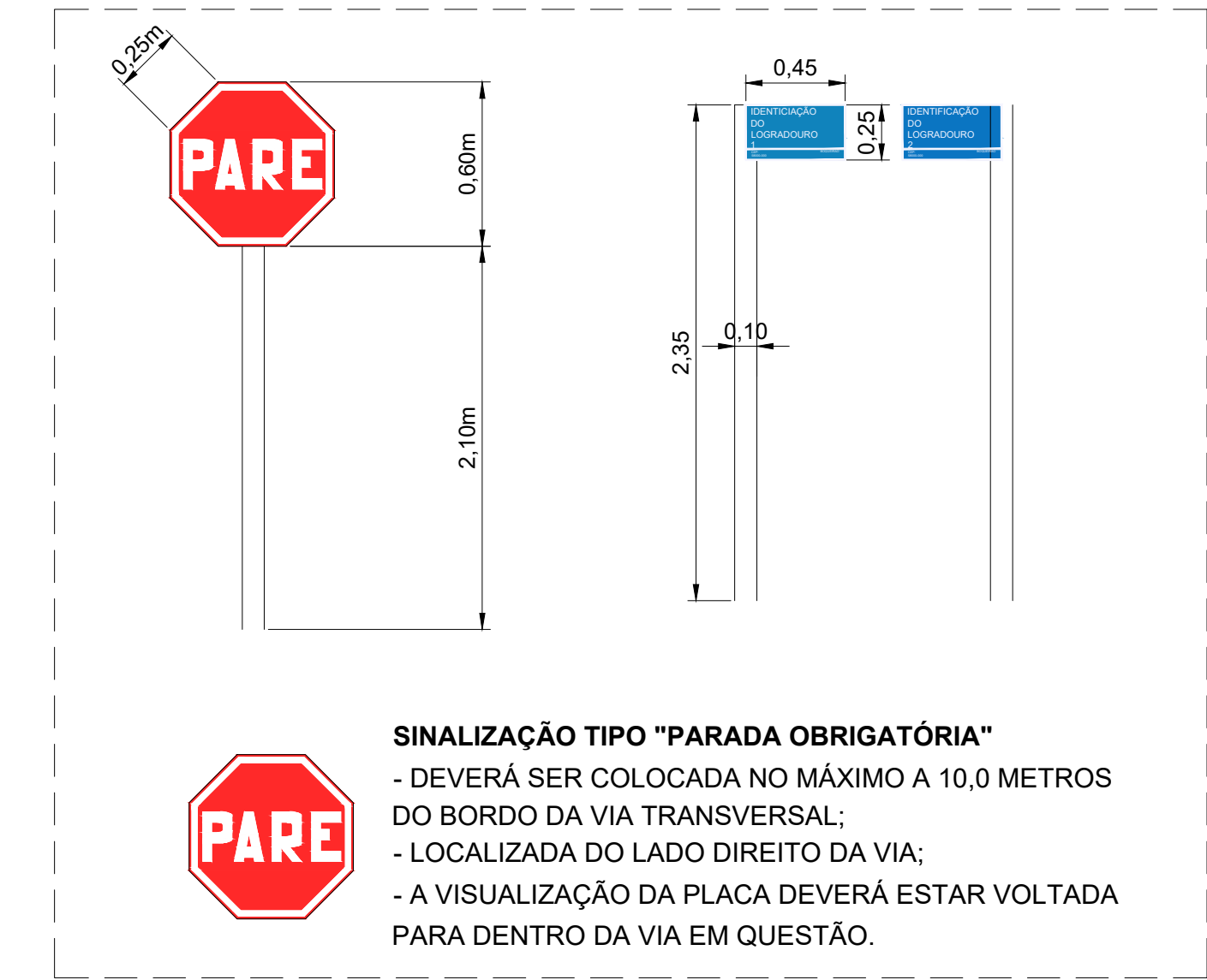
Detalhe da Sinalização Vertical Escala — S/E
