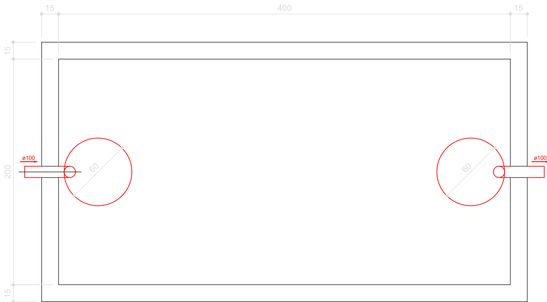
TANQUE SÉPTICO PLANTA BAIXA - ESC. 1:25
