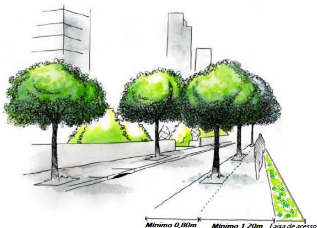
Figura 24 – Dimensionamento mínimo do passeio e faixa de servidão. Fonte: Prefeitura Municipal de São Paulo, 2015.
