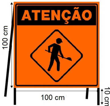
Imagem 02: Exemplo de placa R-24 "OBRAS" montada em cavalete.
