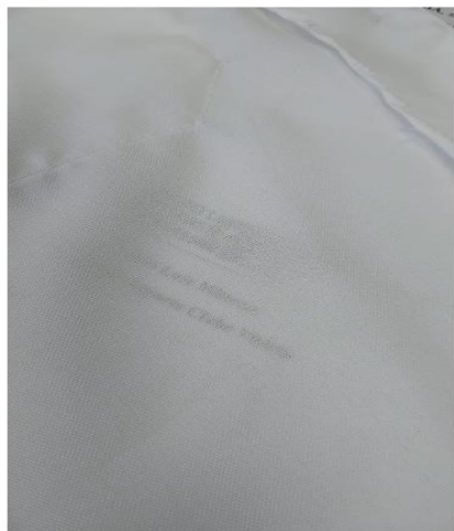
Tecido transparente, armado, de péssima qualidade
