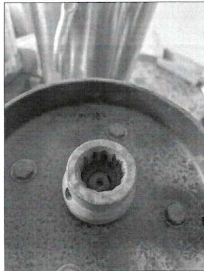
Figura 04: Acoplador do liquidificador industrial de 08 litros da marca "SKYMSEN", que apesar de sinais de oxidação, por ser um material metálico ainda possui funcionamento. Demonstrando resistência superior aos demais modelos e marcas.
