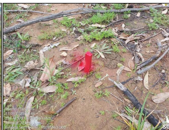
Figura 3. Piquete na cor vermelha demarcando o local proposto para perfuração do poço. Fonte: VLGeo (2025).
