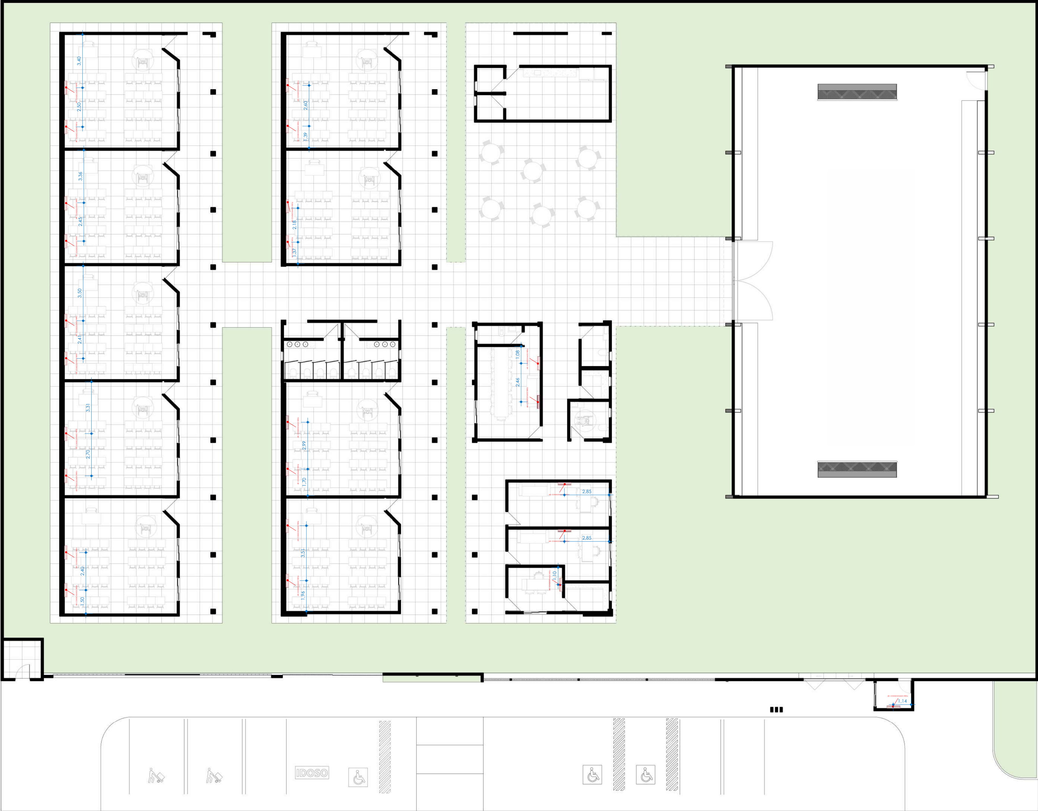
PLANTA BAIXA- PONTOS AR CONDICIONADO ESC:1 : 140
