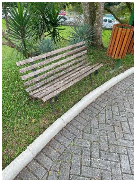
Fotografia 124 - Degradação de madeira
