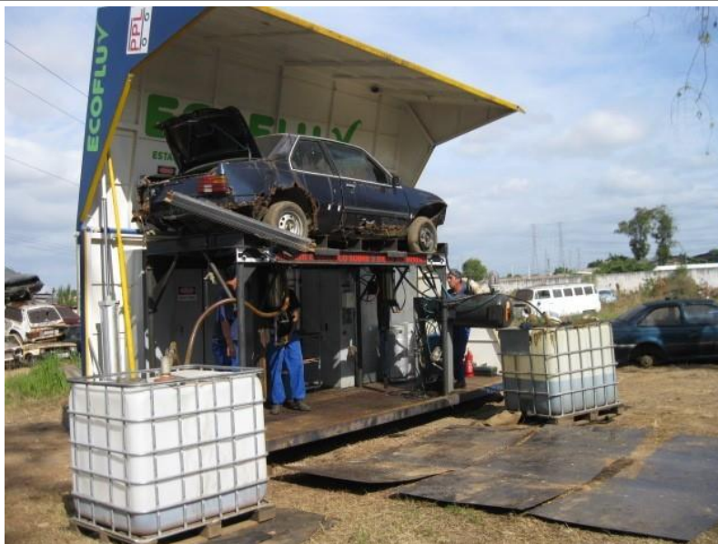
Fig.39 - Ambiente com óleos, graxas, líquidos inflamáveis e risco de explosão;
