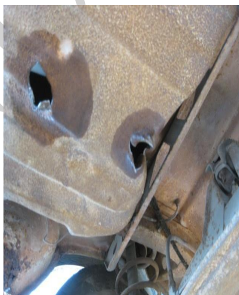
Fig.4 - Retirada de Combustível – Perfuração do Tanque;
