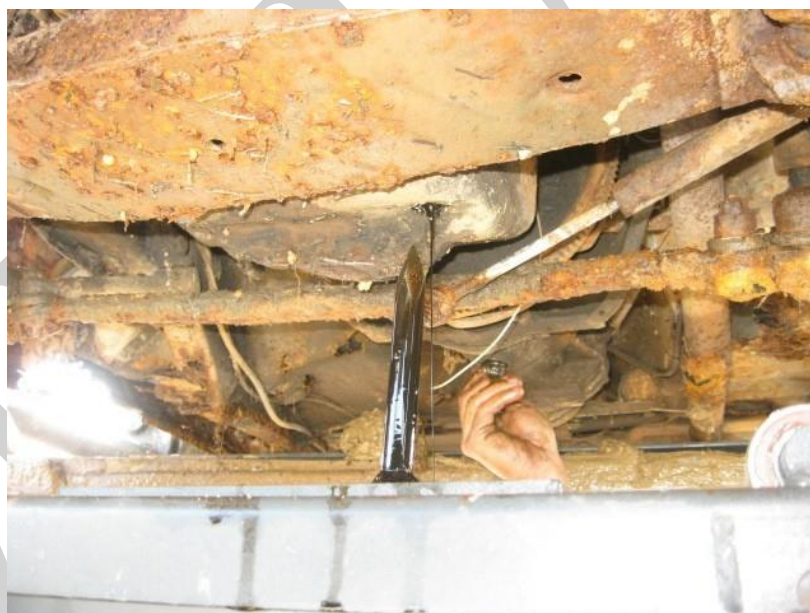
Fig.5 - Reservatório de coleta de fluidos – Combustível ou Lubrificantes; Fig.6 - Retirada de óleo do motor – Perfuração do Carter;
