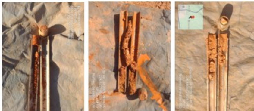
Figura 7 – Amostras coletadas no amostrador do ensaio SPT 03
