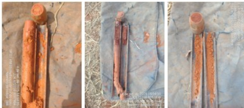
Figura 3 – Amostras coletadas no amostrador do ensaio SPT 01
