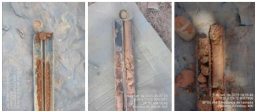
Figura 11 – Amostras coletadas no amostrador do ensaio SPT 05
