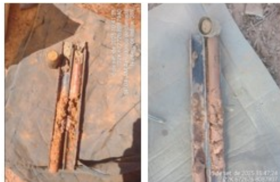
Figura 9 – Amostras coletadas no amostrador do ensaio SPT 04
