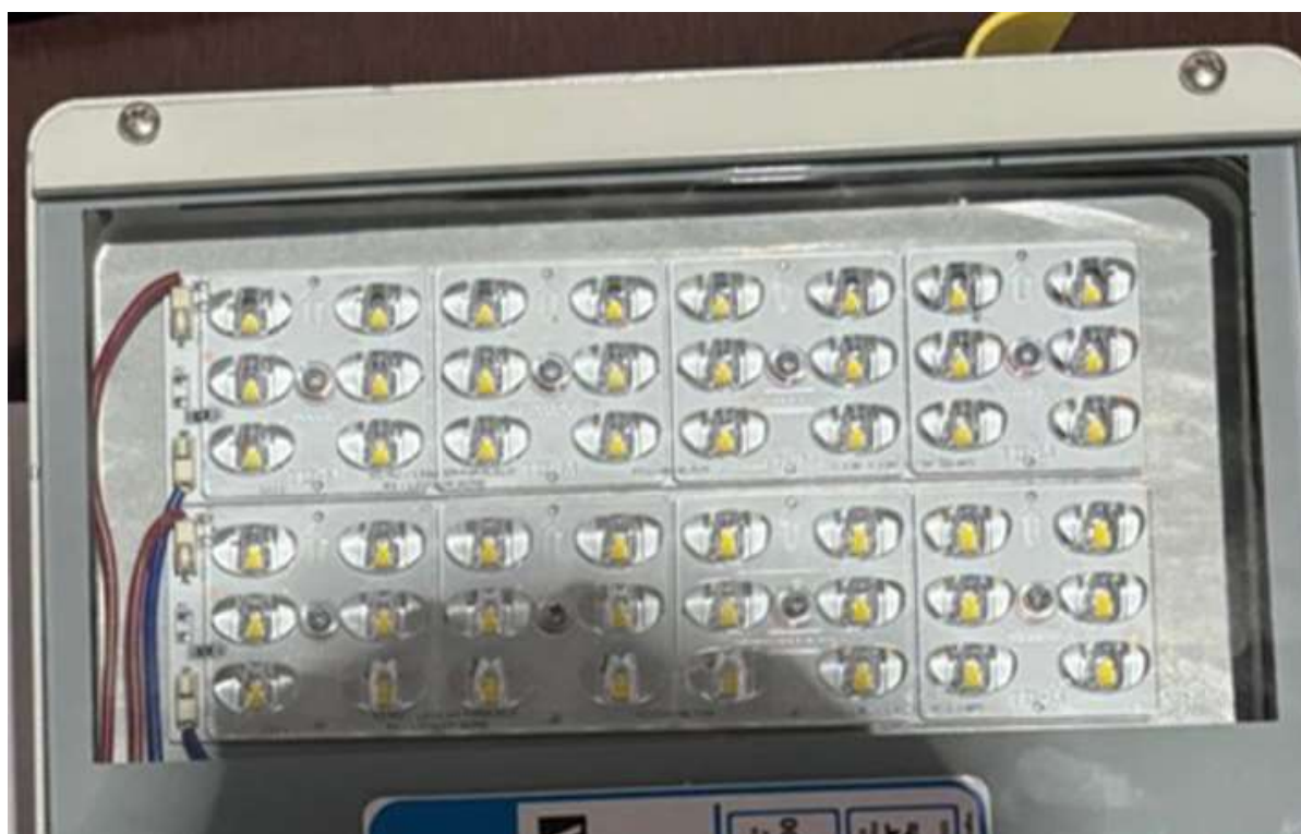
Luminária em desconformidade apresentada em amostra sem certificação, completamente divergente da certificada no INMETRO
