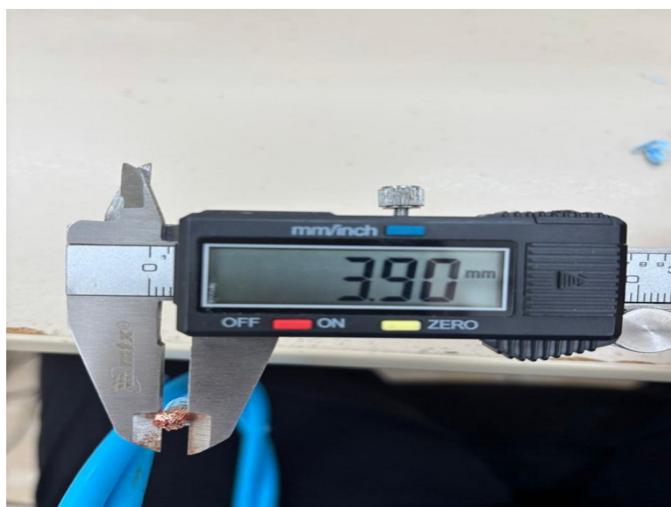
Foto 17: Amostra do Cabo de Cobre Flexível Isolado, 10 mm 2 0,6/1,0 KV
