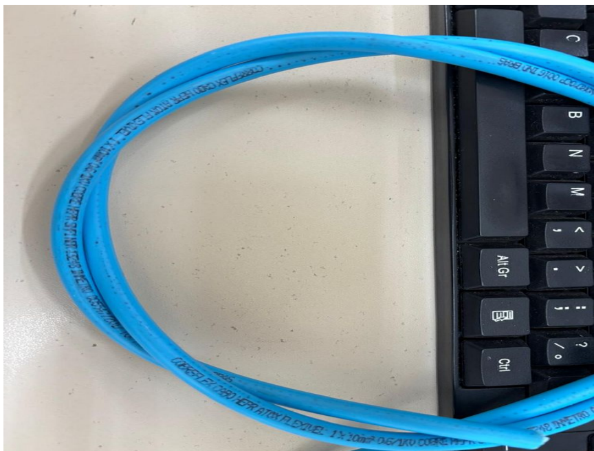
Foto 18: Amostra do Cabo de Cobre Flexível Isolado, 10 mm 2 0,6/1,0 KV
