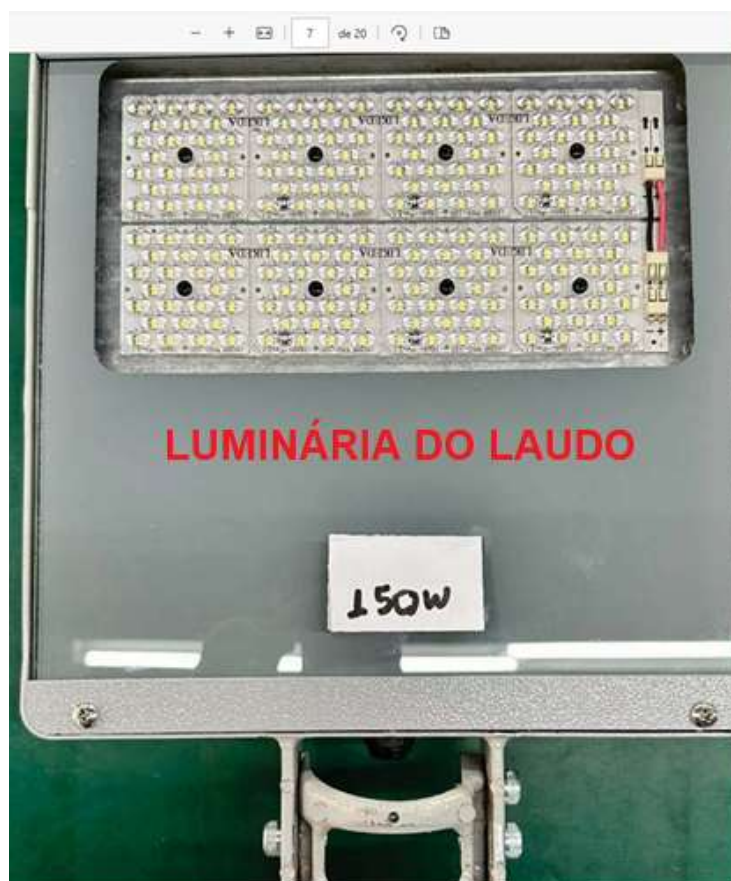
Foto da luminária conforme pag. 07 do Relatório de Ensaio Certificado TOP 07 099-2023 X luminária apresentada na amostra.
