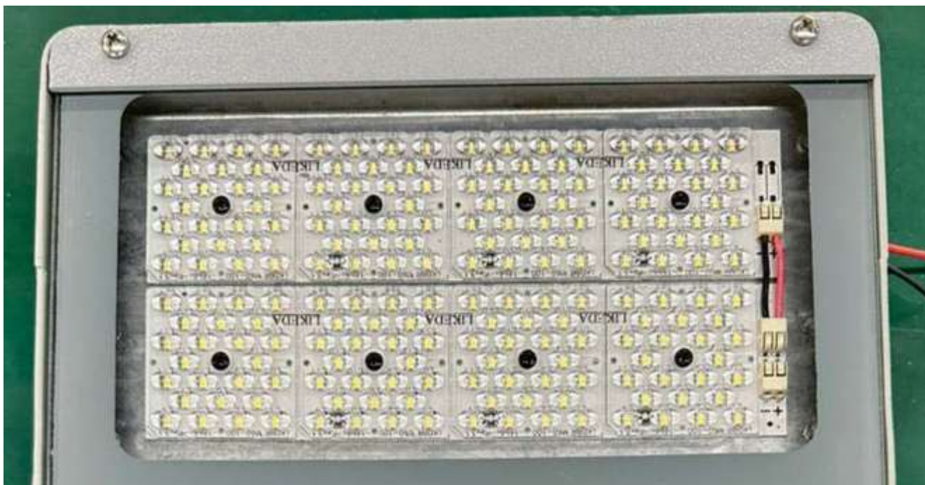
Luminária conforme Pag. 07 do Relatório de Ensaio Certificado TOP 07 099-2023 02 placas com 96 leds modelo 30x30 da marca LIKEDA total 192 leds
