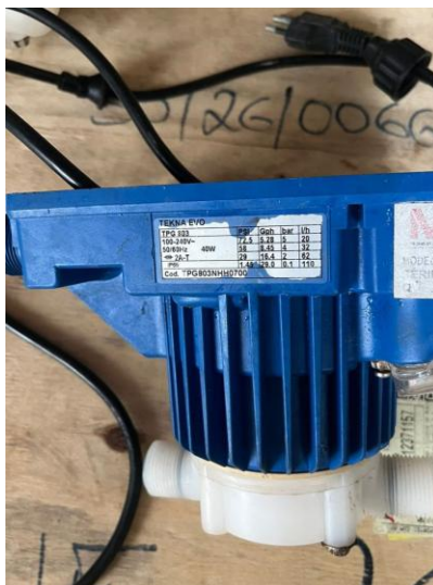
Figura 8 - Bomba SEKO utilizada para desinfecção da água
