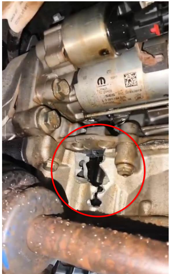
Imagem 02 – Furo na parte traseira do motor
