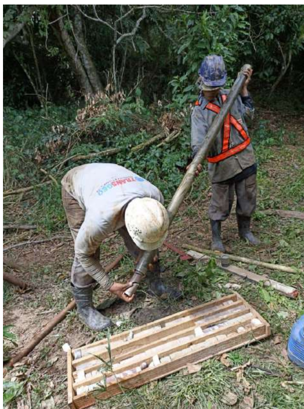
Figura 20 – Execução da sondagem mista (autoria própria, 2024)
