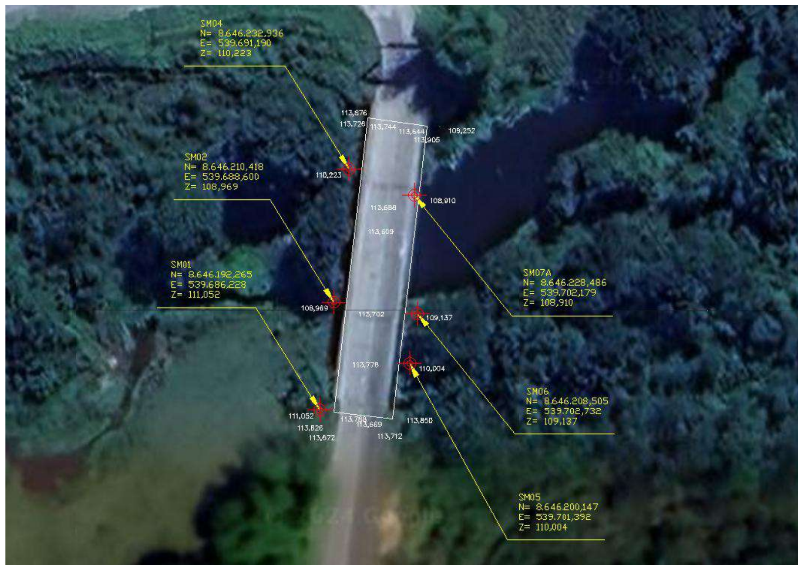
Figura 3 – Imagem de localização dos furos realizados (Google Earth, 2024)
