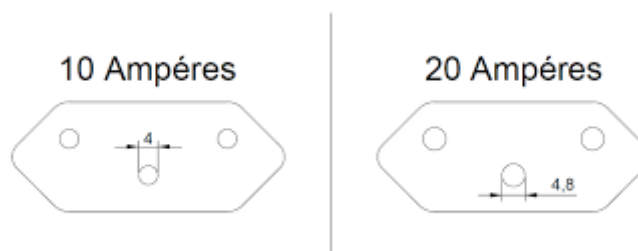
Figura 7 - Dimensão do plug das tomadas de 10A e 20A
