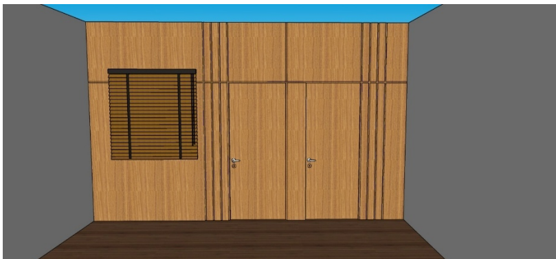
Imagem 03 (Sala de Reunião) – Painel Lisos nas paredes e porta existente.
