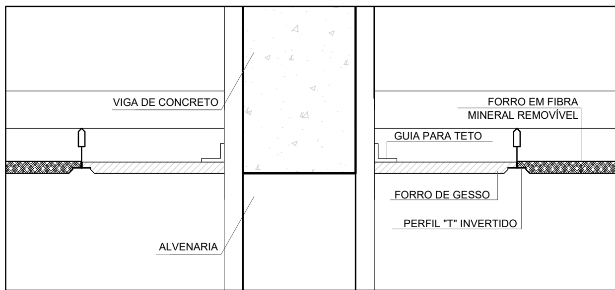
DETALHE 2: FORRO MINERAL E GESSO ESCALA 1/5
