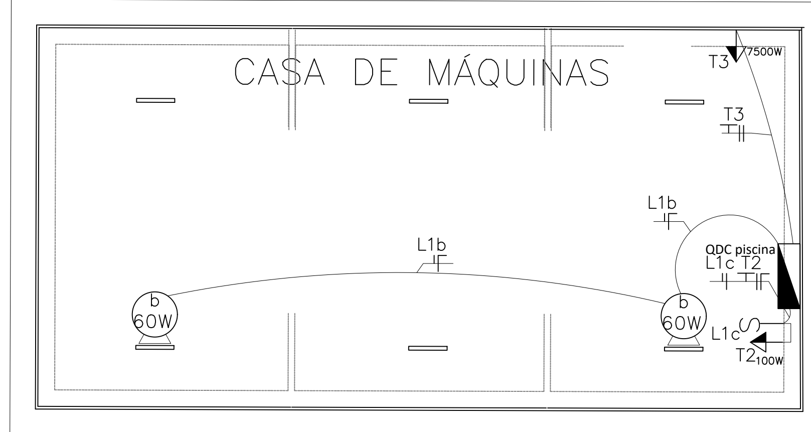
DETALHAMENTO CASA DE MAQUINAS
