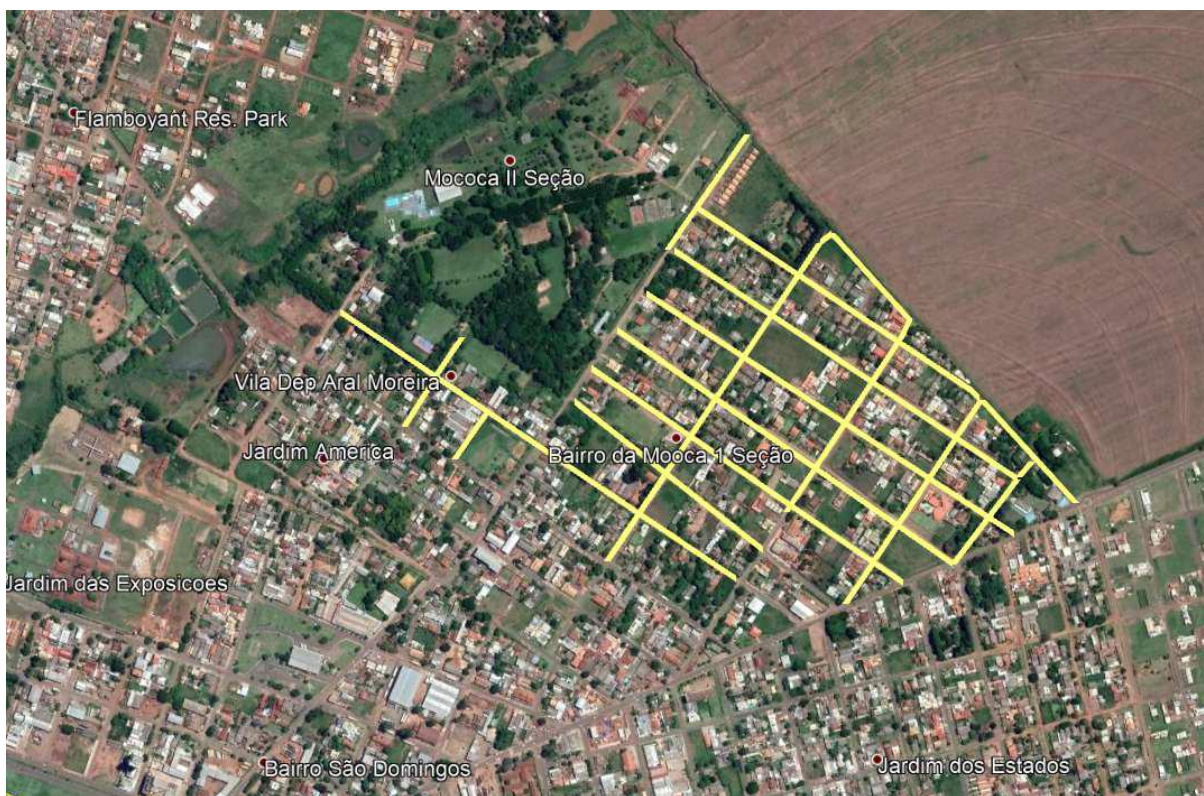
Figura 1 - Implantação da pavimentação, traçado em amarelo
