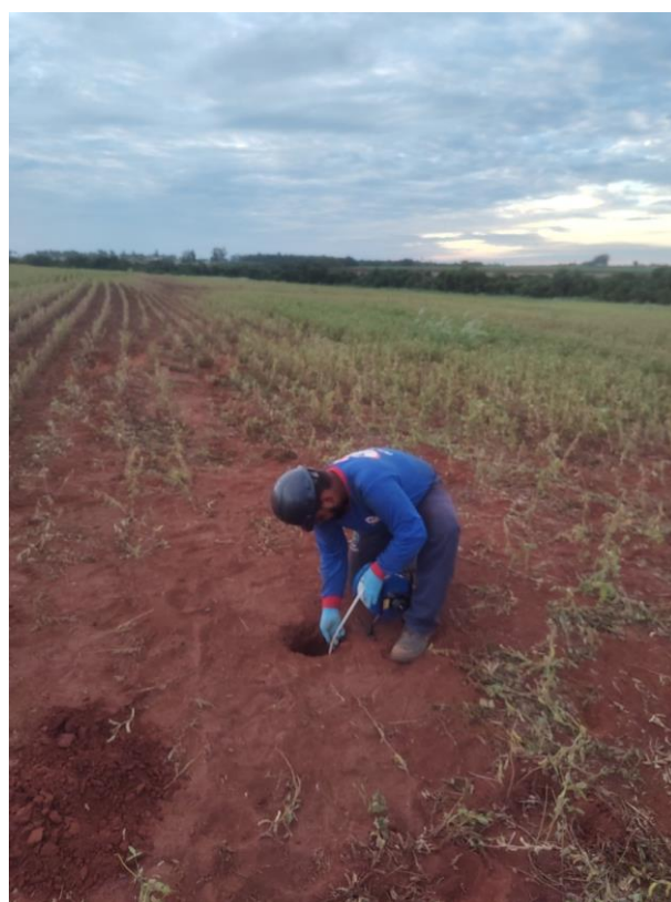
Figura 25 – Medição do NA – P06.
