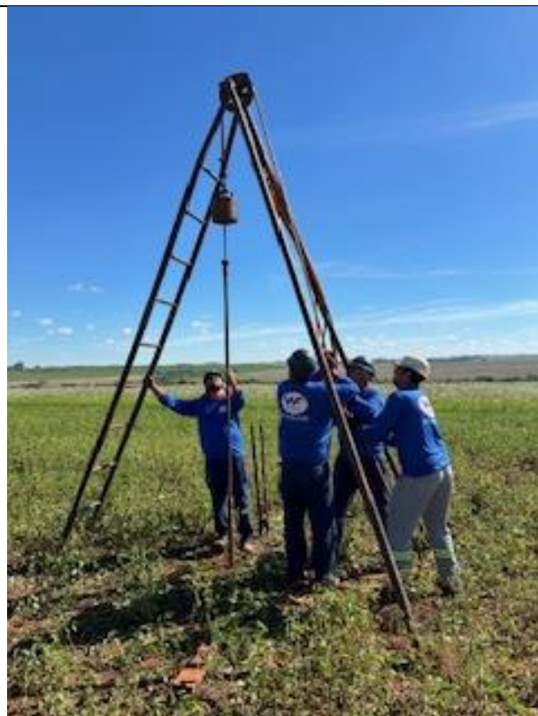
Figura 16 – Sondagem SPT P09.
