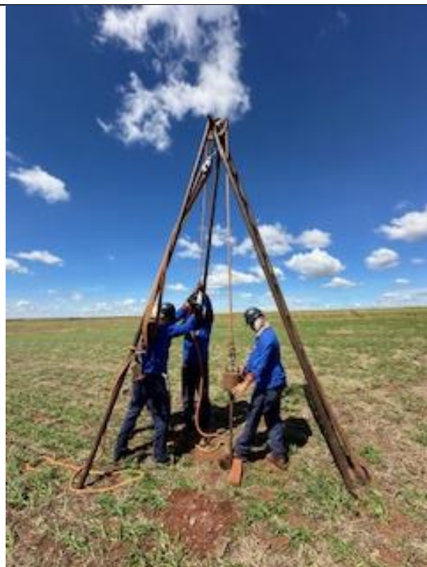
Figura 17 – Sondagem SPT P07.
