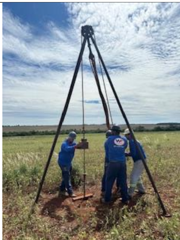
Figura 19 – Sondagem SPT P02.
