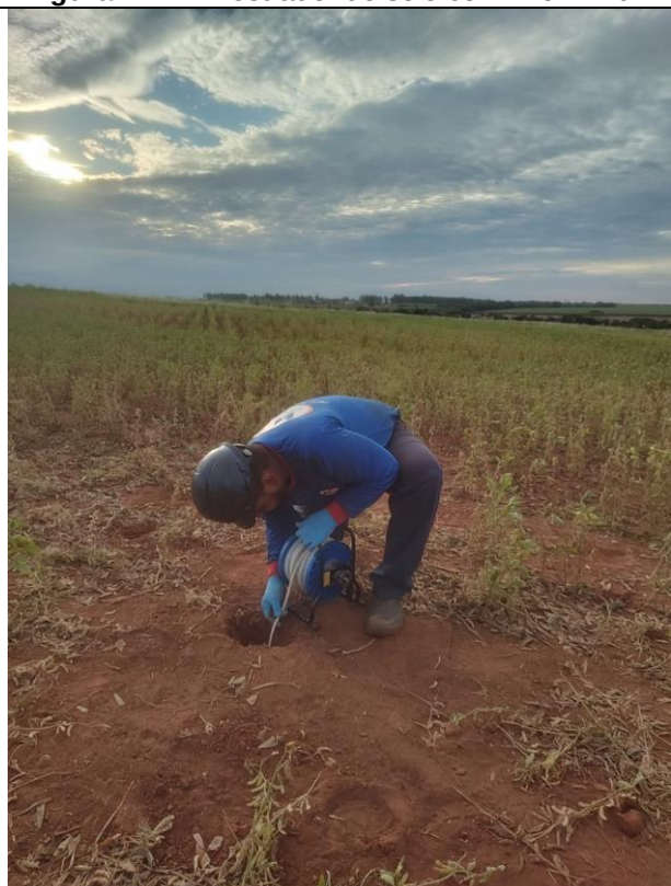
Figura 23 – Medição do NA – P08.
