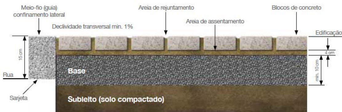
Figura 24 – Seção Transversal Tipo - Pavimento Intertravado
