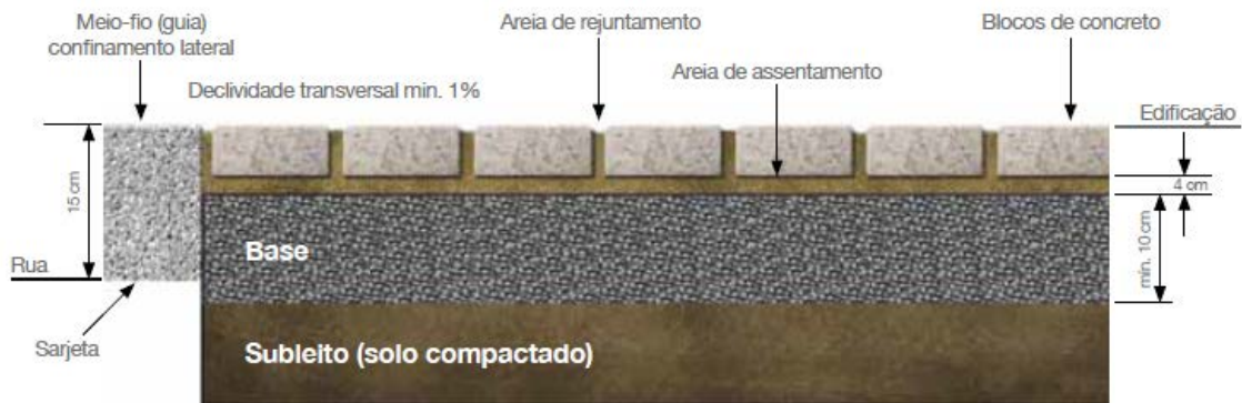
Figura 11 – Seção Transversal Tipo - Pavimento Intertravado
