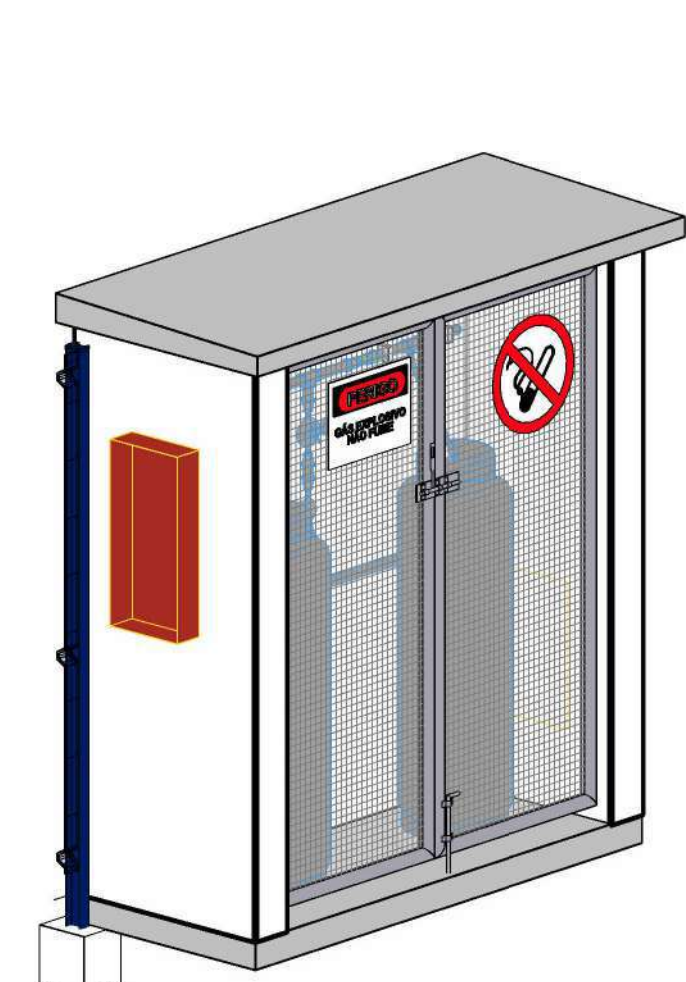
4 CENTRAL DE GLP
