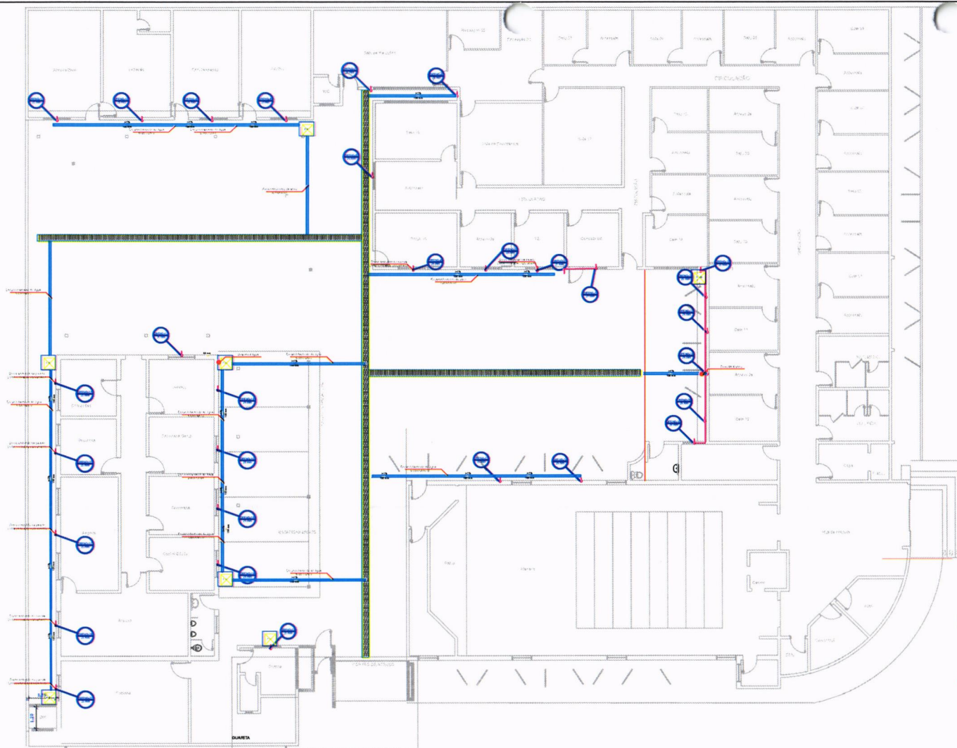
1 PLANTA DE INSTALAÇÕES HIDROSSANITÁRIA - ÁGUA PLUVIAL ESCALA 1/100
