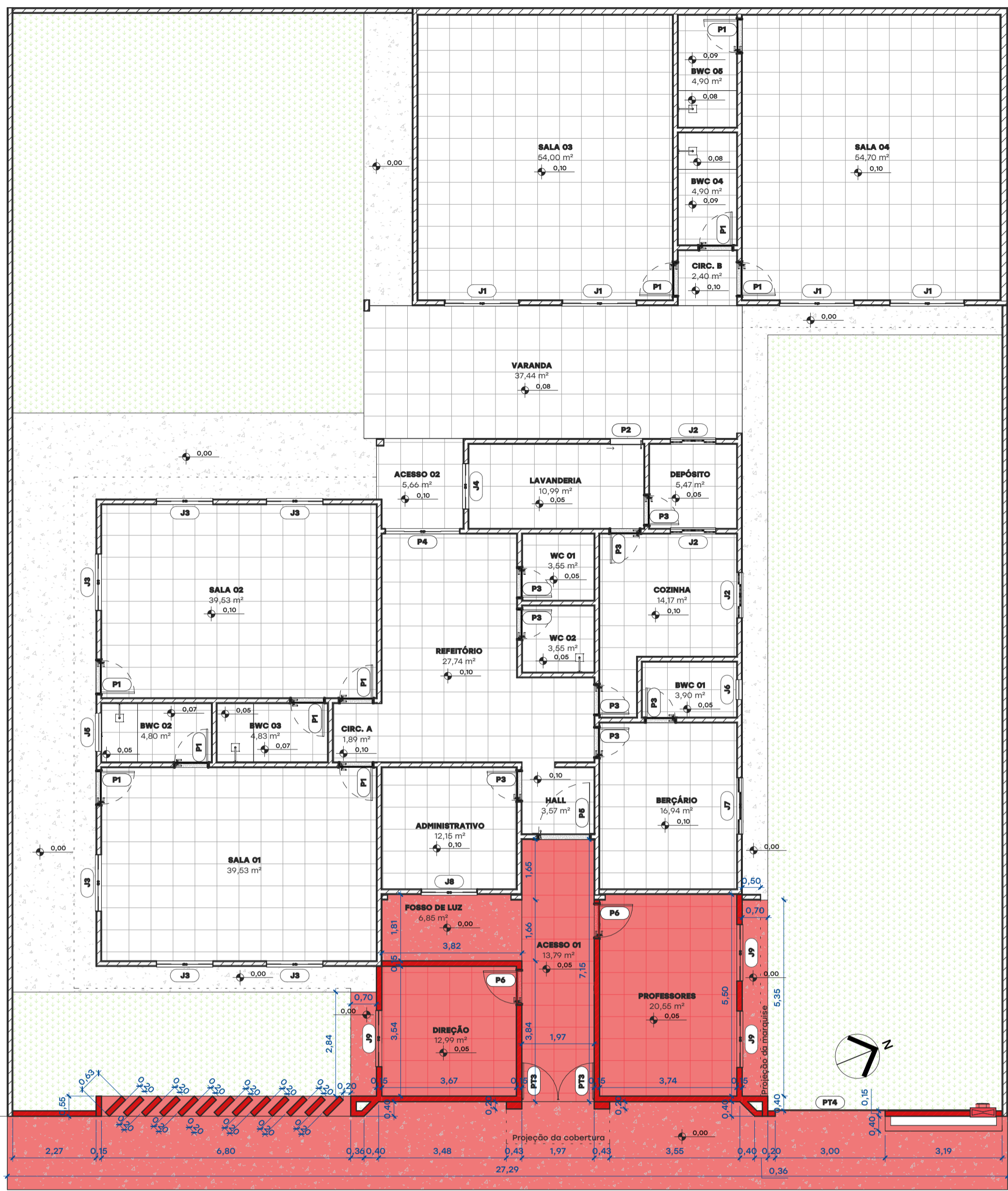
PLANTA DE AMPLIAÇÃO - TÉRREO ESCALA 1:100
