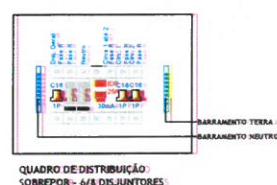
04 DETALHE QUADRO DE DISTRIBUIÇÃO 1: 5
