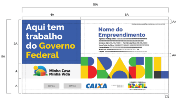
Figura 1. Especificações de placa de obra.
