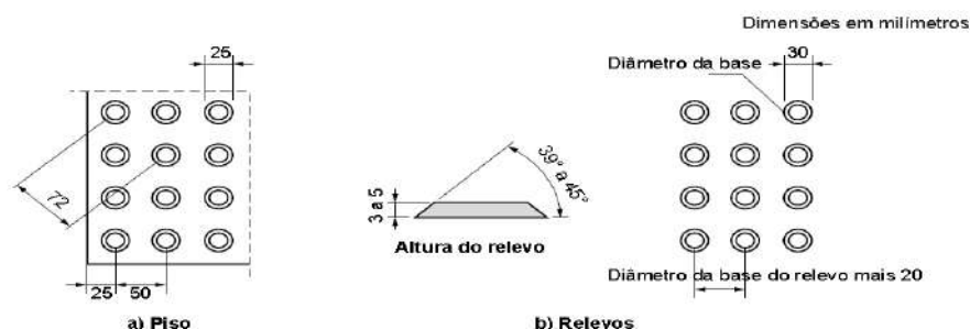
Figura 06 – Sinalização tátil de alerta e relevos táteis de alerta instalados no piso.
