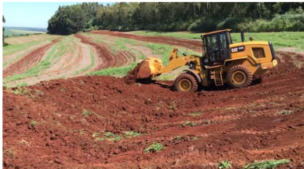
Figuras 7 - Movimentação de solo (de cima para baixo) em direção da linha de demarcação do terraço para formação do camalhão.
