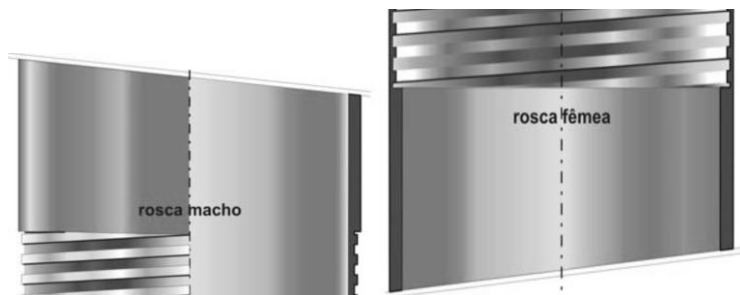
Figura 1 – Detalhe da rosca tipo flush joint (Norma AWWA) em tubo de aço SCH 40.
