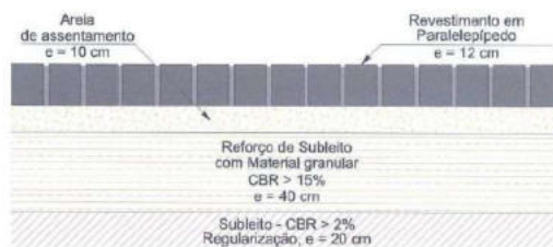
Figura 01 – Seção do pavimento recuperado
