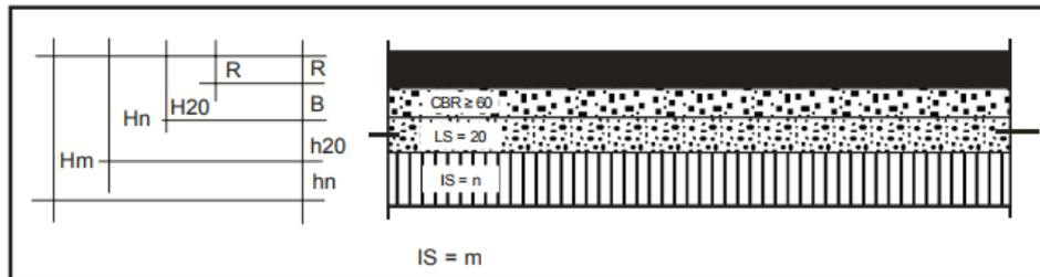
Para os casos em que  $N \leq 10^6$  admite-se o Tratamento Superficial Duplo (TSD), aonde as camadas regulares ou reperfilamento, devem ter a espessura por camada de até 1,5 x a dimensão do maior agregado componente do traço, sendo assim, para os casos do “*Procedimento Simplificado Para Pavimentação Urbana*” em que irá ser utilizado Pedra Britada Nº 2 sua camada de revestimento será de 1” = 2,5 cm.
