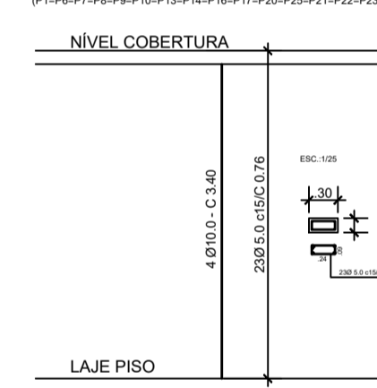
ARMADURA DOS PILARES ESCALA: 1/50
