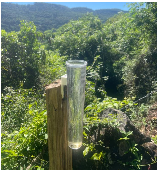
Figura 4 - Imagem do pluviômetro simples posicionado no km181 totalmente preenchido, denunciando a intensidade da chuva naquele local durante menos de 12 horas.
