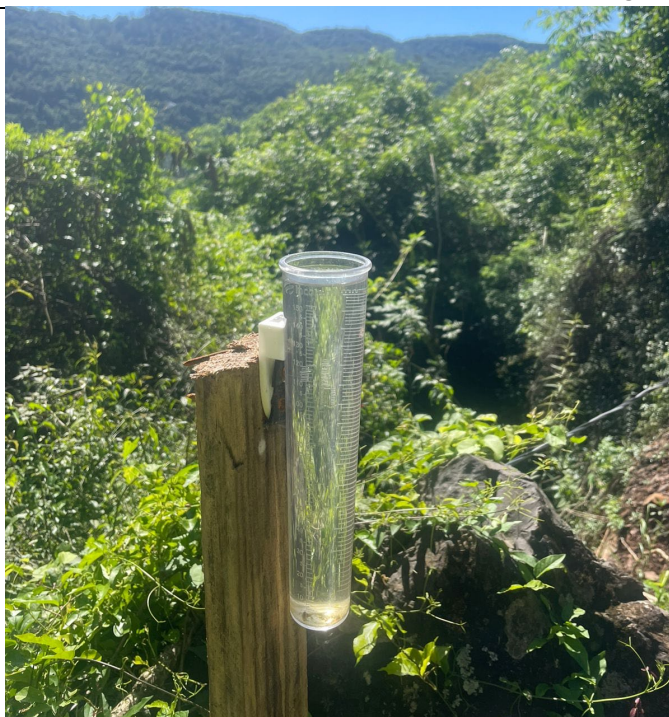
Figura 3 - Imagem do pluviômetro simples posicionado no km181 totalmente preenchido, denunciando a intensidade da chuva naquele local durante menos de 12 horas.
