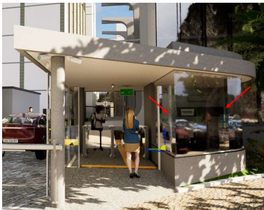
Localização da instalação do vidro blindado na nova guarita.
