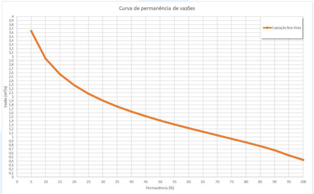
Figura 5. Curva de permanência de vazões para a bacia de contribuição do Ribeirão Boa Vista, no eixo proposto para o barramento
