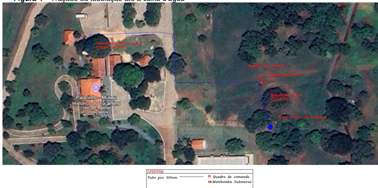
Figura 4 – Traçado da tubulação até à caixa d'água
