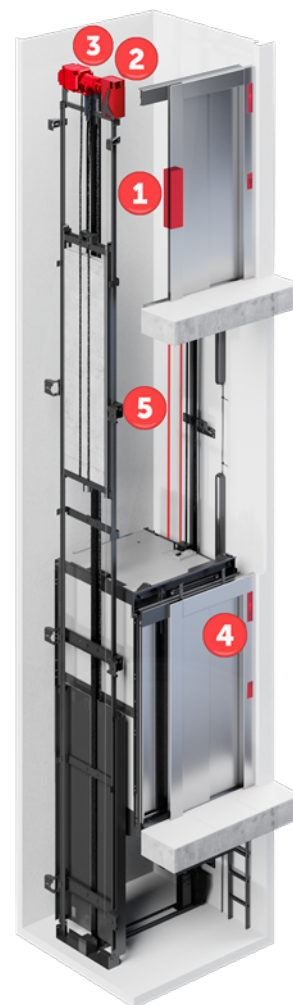
1. Controlador, 2. Inversor, 3. Máquina, incluindo correias ou cabos, 4. Acessórios, 5. Soluções elétricas
